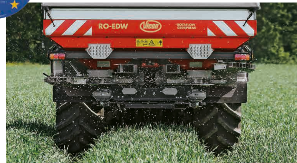
Strooien naar de kant toe met de TrimFlow
