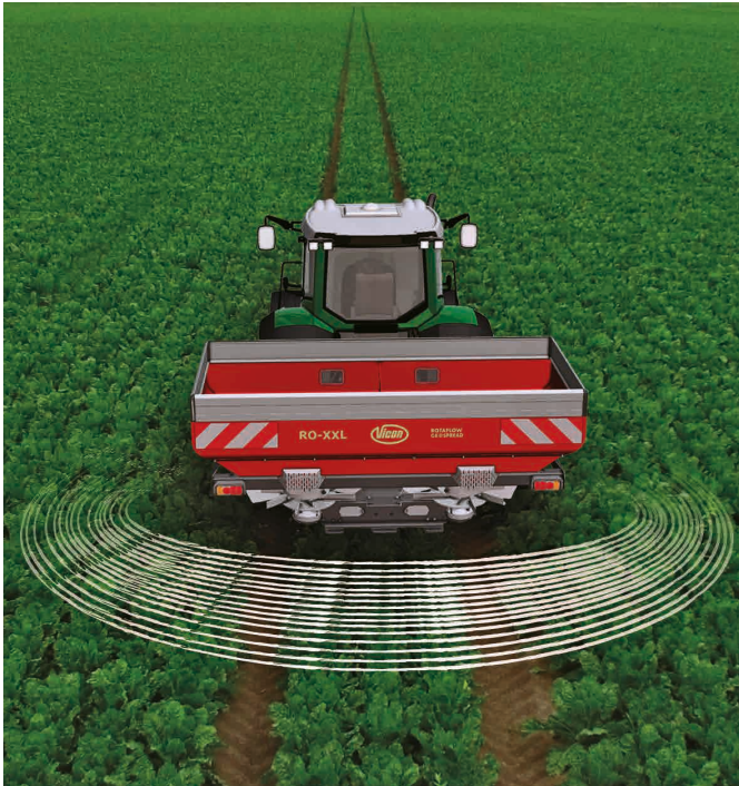
Vicon RotaFlow strooiers - 8 schoepen per schijf
