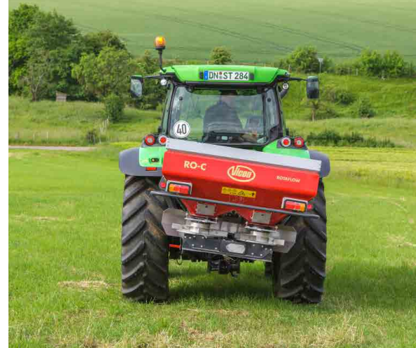
Kantstrooien vanuit het spoor - strooien tot aan de grens met de schuinstelcilinder
