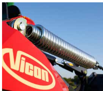
De grote compensatieveer zorgt voor een uitstekende flotatie over de volledige maaibreedte.
