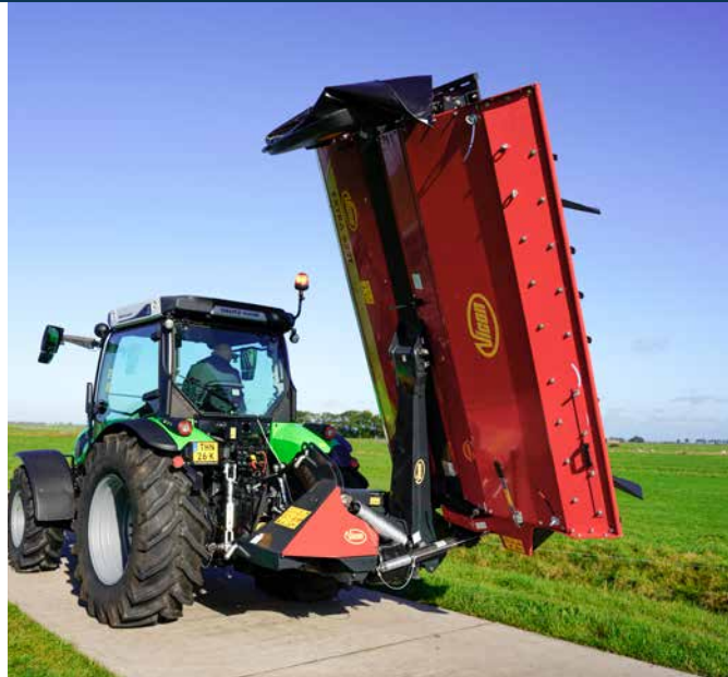
EXTRA 624T, 628T/R en 632T Farmer worden ingeklapt in verticale transportstand met behulp van een hydraulische cilinder.
