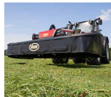
Ruime kopakkerpositie van maar liefst 420mm zonder het verstellen van de frontheef.
