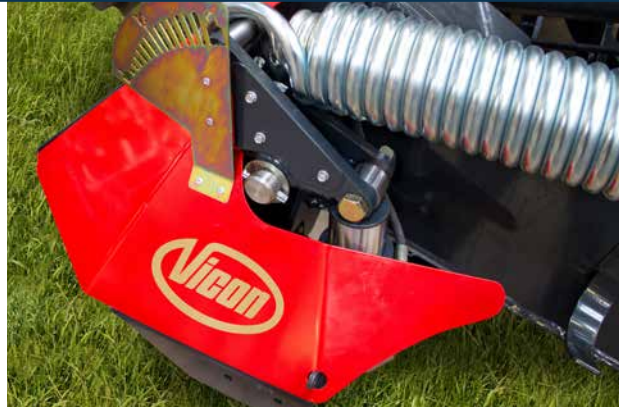
Uitgerust met optionele hydraulische instelling van de bodemdruk.
