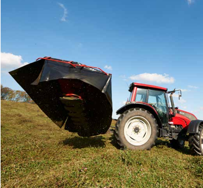
Uitheffen op de kopakker m.b.v. hydraulische cilinder.
