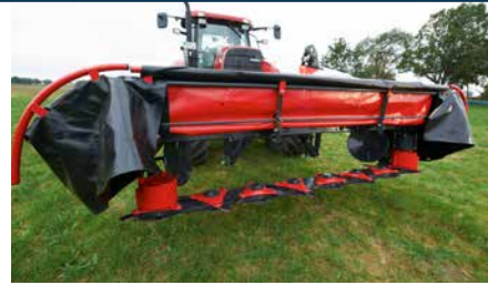
Gemakkelijk toegankelijke maaibalk met opklapbare front- en zijkappen.
